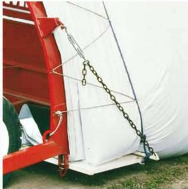
Para la colocación de la bolsa, tiene un sistema de carga y colocación que facilita enormemente esta operación, sin necesidad de subirse a la máquina.
