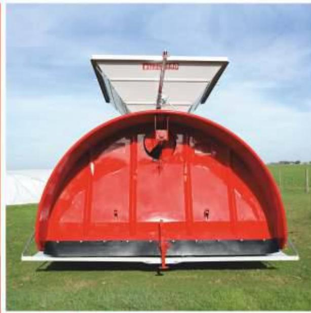
Esta máquina embute el grano que recibe por la tolva en una bolsa de material plástico resistente de 9' de diámetro. A medida que se embute el cereal, la máquina y el tractor que la acciona avanzan por el empuje del propio grano. Cada bolsa puede embutir aproximadamente 200 t de grano y la capacidad de trabajo de la máquina es de 550 t/h.
