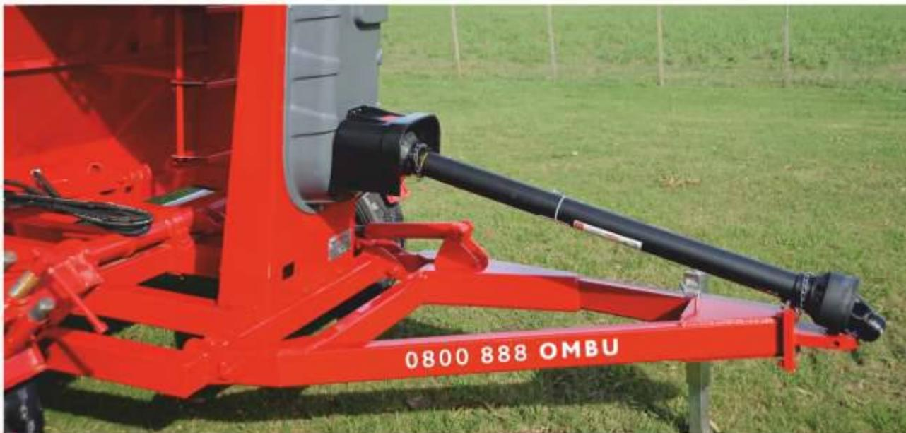
El accionamiento se logra mediante un mando cardánico con reducción de cadena ASA 80, muy robusta.
