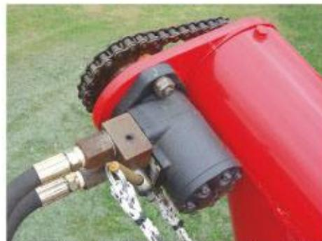
Motor hidráulico con multiplicador de velocidad.
