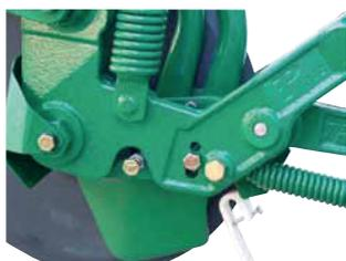
Sistema de zapata de altura regulable, permite prolongar la vida útil del conjunto zapata - disco. Pat. Pend.
