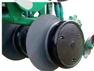
Rueda niveladora con llanta de labio metálico limpiador. Posibilidad de extracción del conjunto rueda niveladora - brazo. Pat. Pend.
