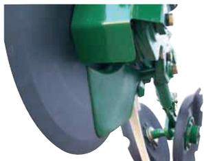
Zapata con tratamiento de dureza y sistema de flotación que le permite estar siempre en contacto con el disco. Patente de Invención AR002802B1. Los tubos de bajada semilla - fertilizante son independientes.
