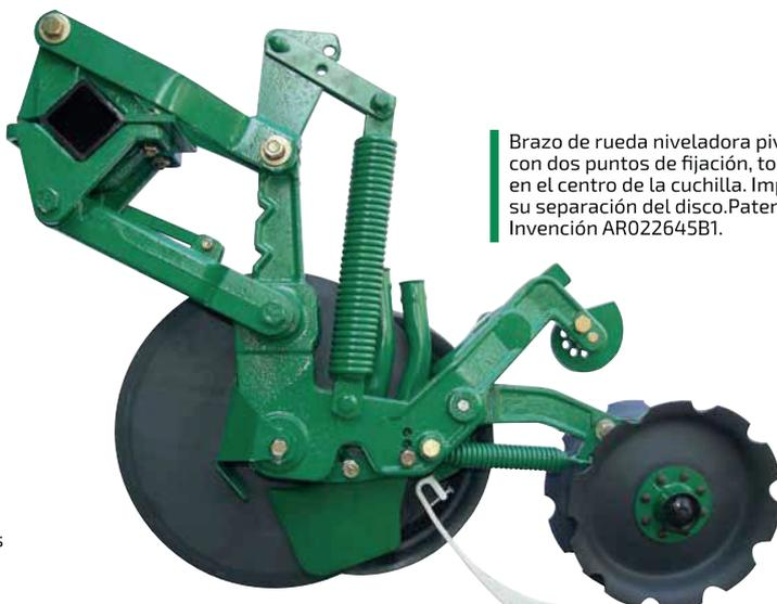
Brazo de rueda niveladora pivotante con dos puntos de fijación, tomado en el centro de la cuchilla. Impiden su separación del disco. Patente de Invención AR022645B1.
