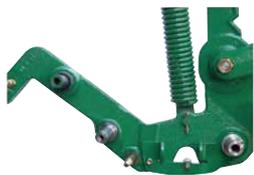
Brazo de fundición nodular con ejes y pernos totalmente recambiables.
