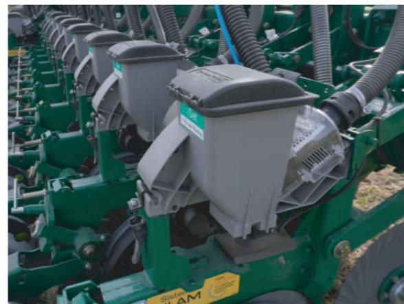
*Dosificador de semillas Neumático Precision Planting vSet2 con mando mecánico y cadena blindada o motor eléctrico vDrive para corte por línea de siembra.*
