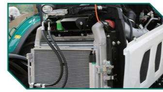
Se optimiza el mecanismo de giro del radiador y agrega una malla a prueba de polvo para facilitar el mantenimiento y la limpieza; aumenta el cuerpo del núcleo de disipación de calor para satisfacer las necesidades de operaciones de mayor potencia.
