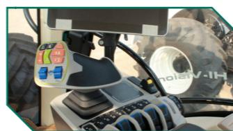
Tiene control de velocidad preciso, ajustable de forma continua de 0 a 40 km/h.
